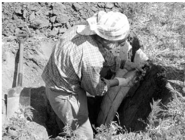
写真2 はぎ取り方法 土壌断面を樹脂で固めて取る
