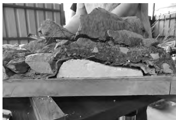
写真6. 発泡スチロール等で空隙を埋める
