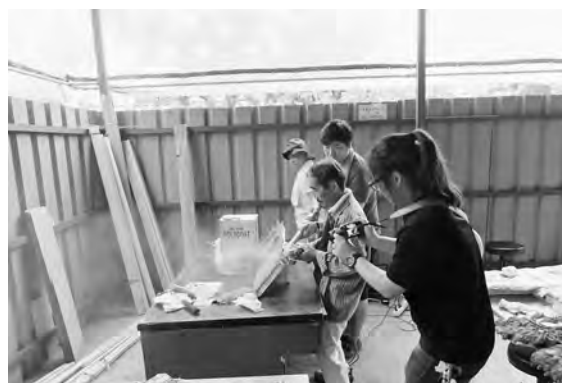
写真4. 台座の大きさに、グラインダー等で成型する
