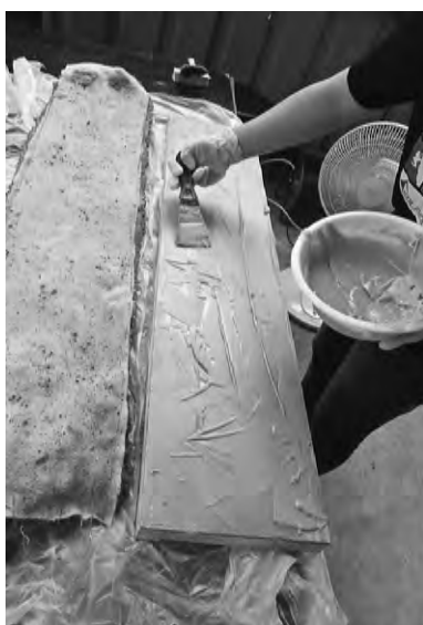
写真1. 台座の部分に樹脂を塗布
